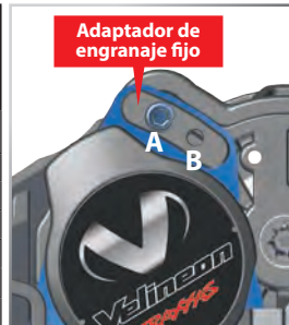
Posición del tornillo del motor en el adaptador de engranaje fijo para ajustar la rueda dentada
