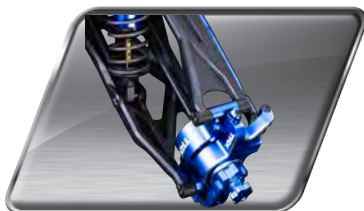
C-Radnaben und Lenkungsblöcke aus Aluminium
