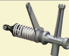
A. Ajuste/afloje la tapa superior
