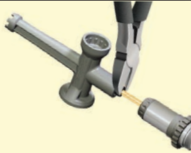
C. Extraiga/instale el cabezal de rótula
